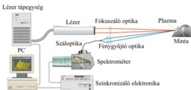
I. ábra Egy LIBS rendszer általános felépítése
